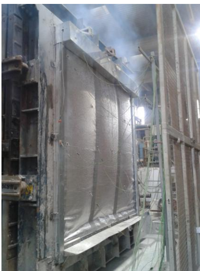
Ensayo en laboratorio de la cortina ARQFIRE E120/EW120
